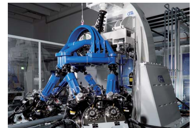
Hydraulischer Hexapod zum Testen mechatronischer Fahrzeugachsen Hydraulic hexapod for testing mechatronic vehicle axles
