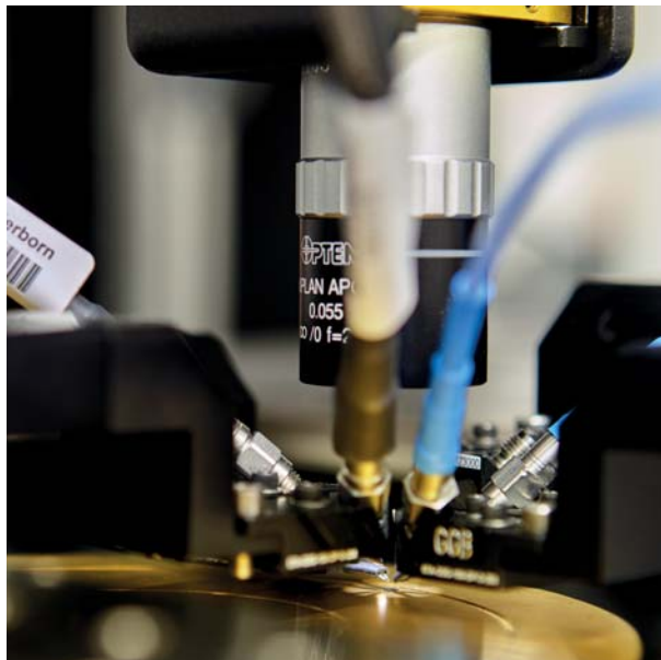
Aufbau zum HF-Test des gefertigten Chips RF test setup of the fabricated chip
