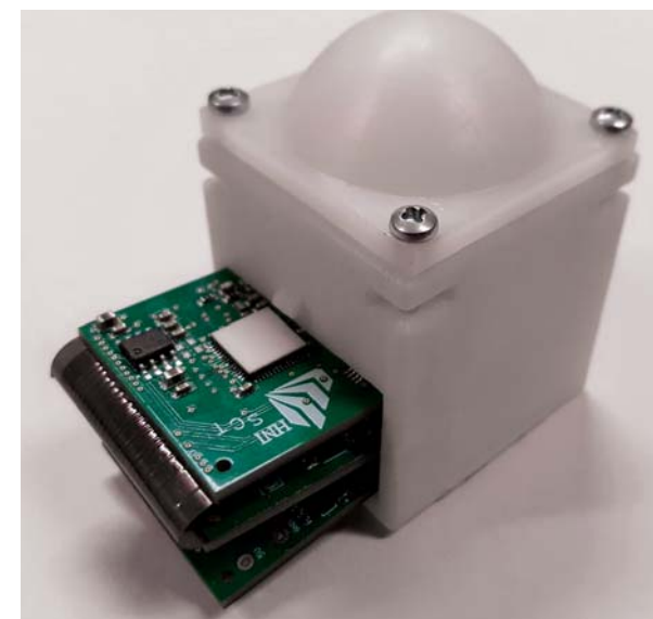
Miniatur-Radar-Modul in Starrflex-Technologie mit Gehäuse Miniature radar module based on rigid flex technology with a housing
