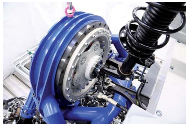
Ankopplungspunkt des Achsradträgers und der Endeffektorplattform des hydraulischen Hexapoden Coupling point of the wheel hub and the hexapod's end effector platform
