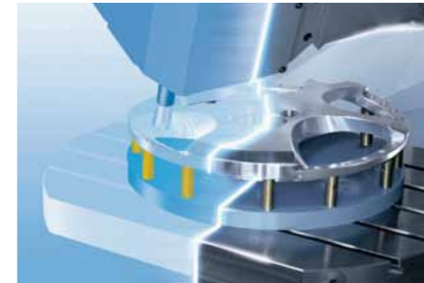
Intelligente Planung – optimale Maschinenauslastung. Arbeitsvorbereitung durch virtuelle Werkzeugmaschinen (DMG MORI SEIKI AG) Intelligent planning – optimum utilisation of machinery Innovation project: Virtual machine tools for production planning (DMG MORI SEIKI AG)
