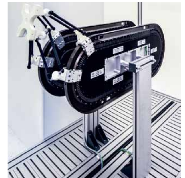
Zwei XTS mit dem experimentellen Parallelroboter beim Durchfahren einer Kurve Two XTS with the experimental parallel robot while traversing a curve
