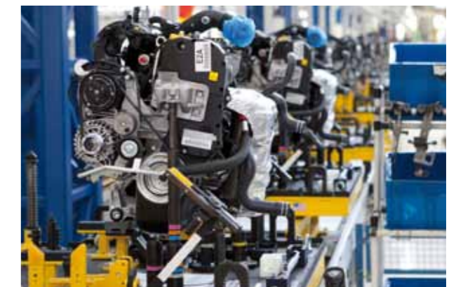
Motorenmontage als Fließproduktion Engine assembly as a serial production
