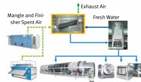
Verknüpfung verschiedener Prozessstufen (Quelle: Kannegiesser) Coupling of Various Process Steps (Source: Kannegiesser)
