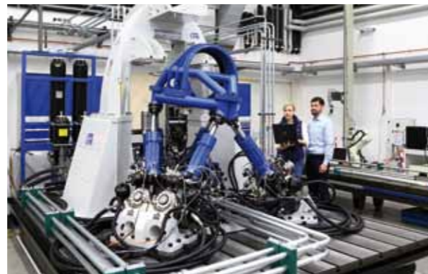
Prüfstand mit hydraulischem Hexapod Test rig with hydraulically actuated hexapod
